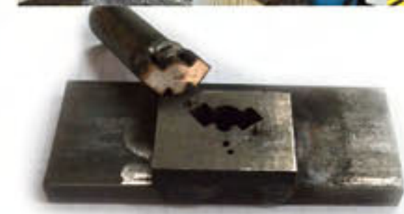
04 Die cutting mould
